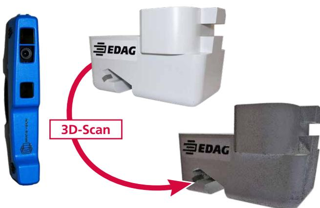
Abhängig von Geometrie und Größe des zu scannenden Objektes kommen unterschiedliche Varianten des Scanners für den Nah- und Fernbereich zum Einsatz. Diese lassen sowohl eine Genauigkeit von bis zu 0,1 mm im Nahbereich, als auch das Scannen von großen Objekten oder ganzen Bereichen zu. Somit ist das 3D-Scanverfahren in den unterschiedlichsten Bereichen flexibel einsetzbar.
