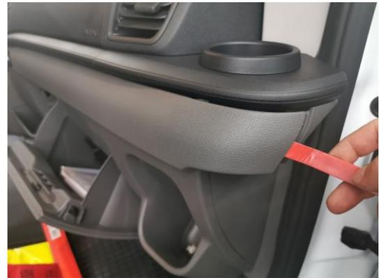
9. Abdeckung Mittelkonsole (26) demontieren. 3x Schrauben mit Torxschraubendreher (TX 25) lösen.
