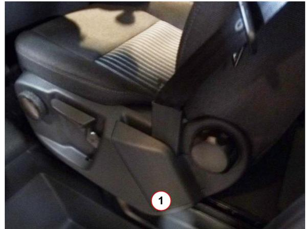
2. Gurtbefestigung (2) lösen (Innensechsrund T45).
