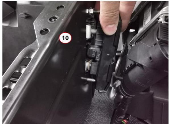
10. Mit Hilfe einer Prüflampe sicherstellen, dass eine elektrische Spannung von 12 V am unteren Befestigungspunkt des Potentialverteilers Fahrersitz (11) anliegt.
