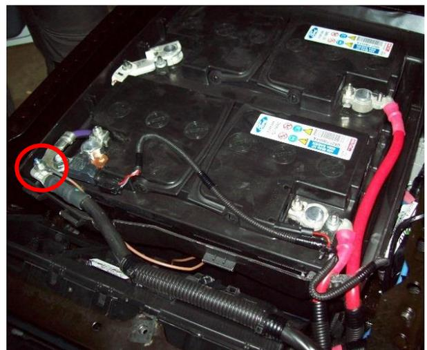
11. Steuergerät (40) mit den restlichen Kabeln durch Öffnung in der Bodenmatte schieben.
