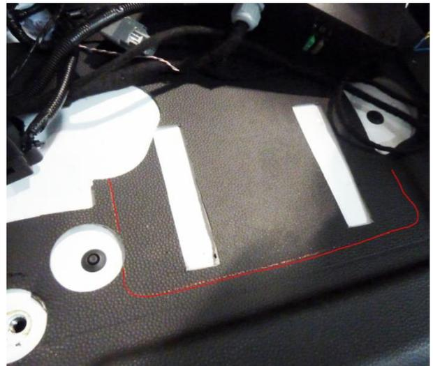
2. Steuergerät (40) mit Acrylic Foam Klebeband (41) befestigen (8 Streifen je 2,5 cm).
