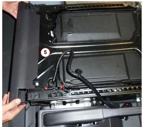
6. Kabeltülle (6) aus Batteriehalter herausziehen.
