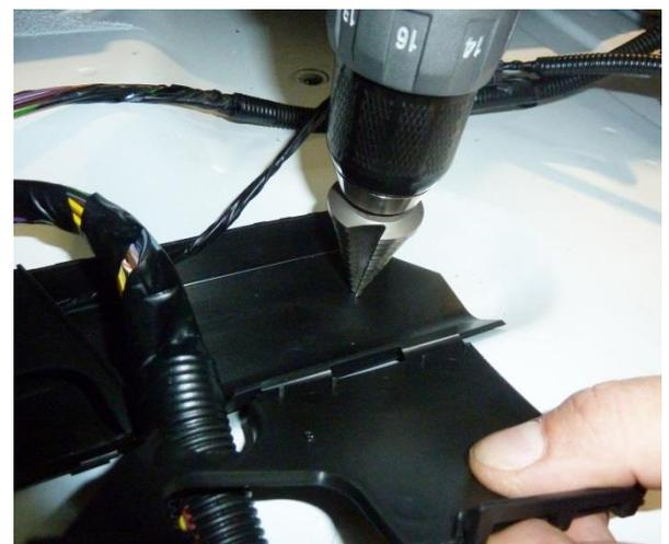
5. Kabelsatz des Linearantriebs durch aufgebohrte Öffnung ziehen. Die Tülle des Kabelsatzes in der Öffnung verankern.
