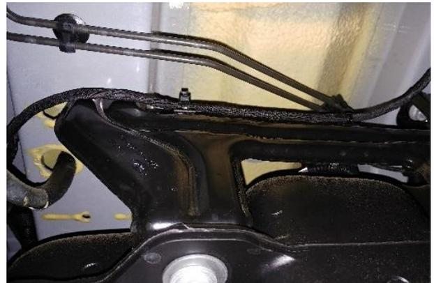
2. Leitungssatz zwischen AdBlue®-Tank und Kraftstofftank verlegen.
