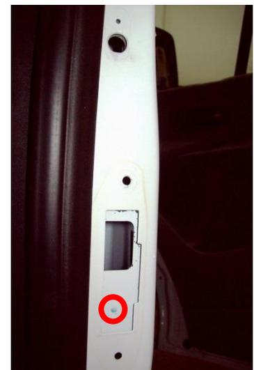
9. Dichtung an Taster anbringen und in Türkontaktplatte einsetzen, mit Gabelschlüssel (Schlüsselweite 19 mm, Drehmoment 1,5 Nm) befestigen.
