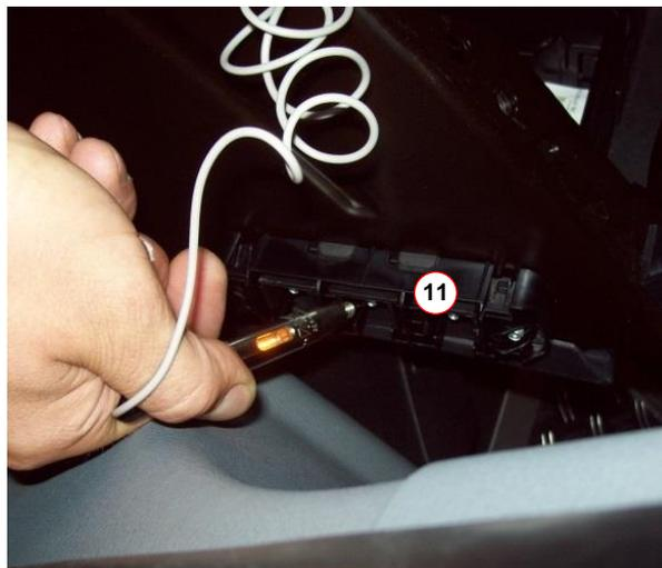
11. Batteriepole mit Schraubenschlüssel (Schlüsselweite 10 mm) lösen.
