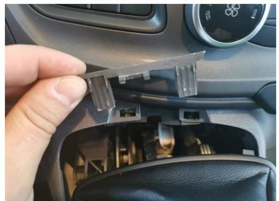
8. Verkleidung oberhalb des Handschuhfachs (25) demontieren (geclipst).
