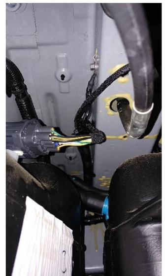
3. Im weiteren Verlauf den Leitungssatz entlang des Längsträgers bzw. des Fahrzeugleitungssatzes verlegen. Leitungssatz an den 5 vorgesehenen, gelb markierten Befestigungspunkten am Fahrzeugleitungssatz befestigen. (Kabelbinder, TN 3395)
