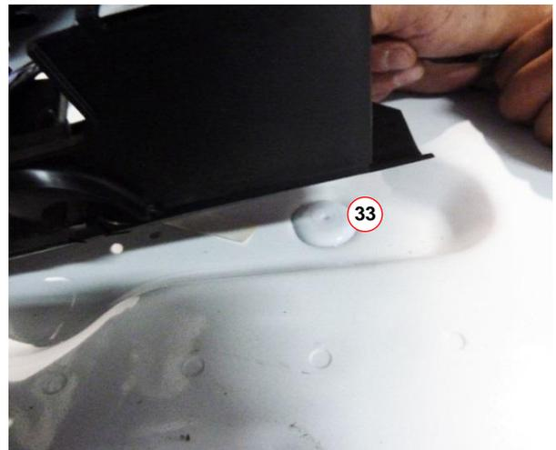
4. Öffnung von Blindstopfen mit Stufenbohrer auf 27-27,5 mm Weite bohren. Beim Bohren sowohl durch den Kabelschacht als auch durch das Blech bohren.
