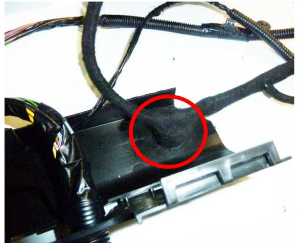
6. Von der Tülle abgehendes Kabel (Spannungsversorgung und Geschwindigkeitssignal) durch Sitzkonsole entlang des Kabelschachtes am Fahrersitz ziehen.
