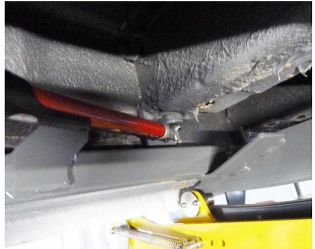
14. Schrauben M8 (TN 2897) im Längsträger außen vorne anbringen und mit 15 Nm anziehen.
