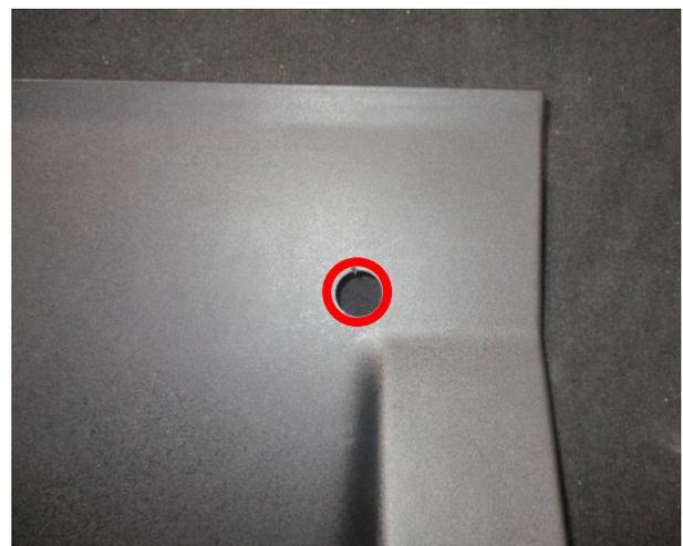
3. Not-Halt-Taster einsetzen. Mutter (Schlüsselweite 24 mm) mit 1,5 Nm verschrauben.
