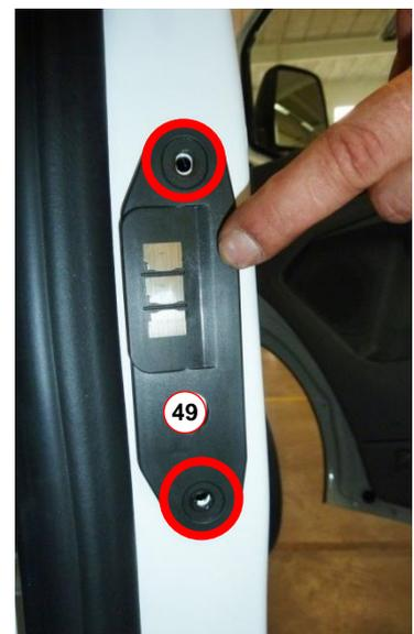
8. Bohrung (Bohrgröße 16 mm) für Türkontaktschalter in Türkontaktplatte setzen. Die Markierung oberhalb des Ford-Logos bezeichnet die exakte Stelle für die Bohrung.
