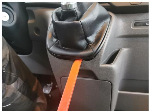
7. Abdeckung (24) oberhalb des Schaltknaufts demontieren.
