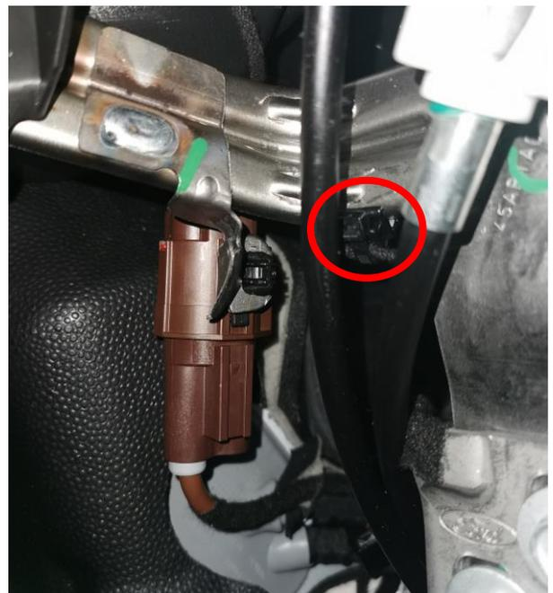
3. Kabel für Warnleuchte (36) wird rechts am Kombiinstrument hindurch geführt.
