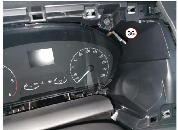
4. Abdeckung Kombiinstrument im Bereich Ecke rechts oben modifizieren, dazu Verstärkungsrippen verschleifen.
