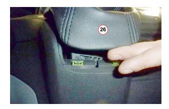
**10.** Abdeckung der Mittelkonsole (27) entfernen.
