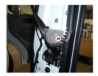
4. Positionierung Türkontaktschalter: Zentral zwischen Türkontaktplatte (49) für Schiebetür und Führungsdorn (50) durch beide Bleche bohren. Bohrgröße 11,5 mm.
