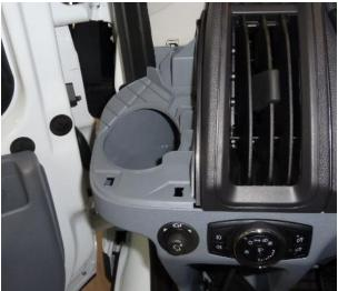
**4.** Zuvor gelegtes Kabel (Warnleuchte) durch die Öffnung hindurchziehen.
