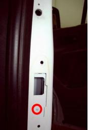
Dichtung an Taster anbringen und in Türkontaktplatte einsetzen, mit Gabelschlüssel (Schlüsselweite 19 mm, Drehmoment 1,5 Nm) befestigen.
