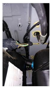
3. Im weiteren Verlauf den Leitungssatz entlang des Längsträgers bzw. des Fahrzeugleitungssatzes verlegen. Leitungssatz an den 5 vorgesehenen, gelb markierten Befestigungspunkten am Fahrzeugleitungssatz befestigen. (Kabelbinder, TN 3395)
