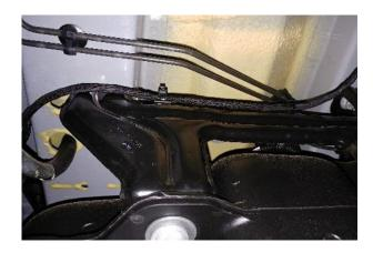
**2.** Leitungssatz zwischen AdBlue®-Tank und Kraftstofftank verlegen.
