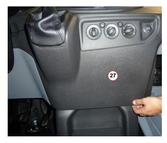
Abdeckkappen auf Fahrer- und Beifahrer-seite (28) demontieren. Darunterliegende Schraube mit Innensechsrund T25 lösen.
