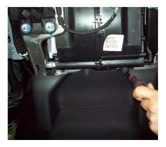
13. Bodenmatte mit zwei selbstangefertigten Hilfsmitteln (30) unterkeilen, um Zugänglichkeit zu Kabelkanälen zu gewährleisten.
