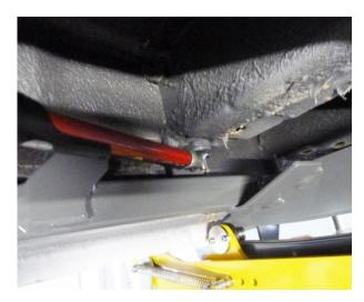
14. Schrauben M8 (TN 2897).im Längsträger außen vorne anbringen und mit 15 Nm anziehen.
