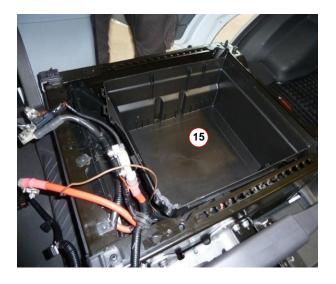
12. Alle abmontierten Batteriepole in korrekter Reihenfolge wieder anklemmen und mit 4,5 Nm anziehen.
