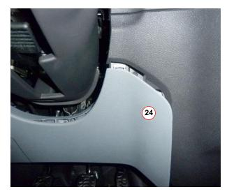
**8.** Verkleidung der Mittelkonsole (25) auf der linken Seite unterhalb des Lenkrads lösen (Schraubendreher Innensechsrund T25).
