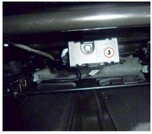
Schrauben der Sitzschiene vorne/hinten (4) (4 x Innensechsrundschraube T40) herausdrehen.Sitz anheben und ausbauen.
