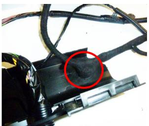
6. Von der Tülle abgehendes Kabel (Spannungsversorgung und Geschwindigkeitssignal) durch Sitzkonsole entlang des Kabelschachtes des Fahrersitzes ziehen.
